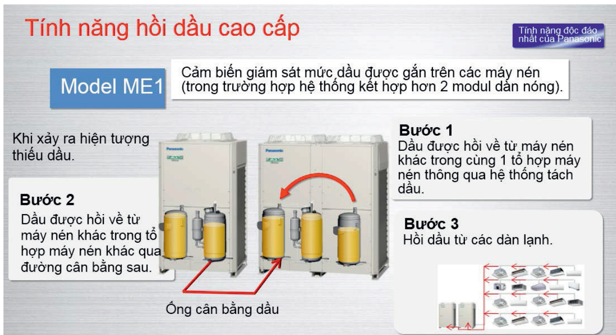
Hình 3: Mô tả công nghệ hồi dầu 3 bước
